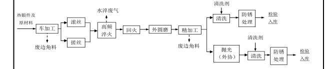
图 4-1 本项目生产工艺流程及产污环节
